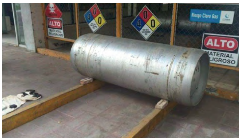
Figura 1. Tanque de gas cloro.
